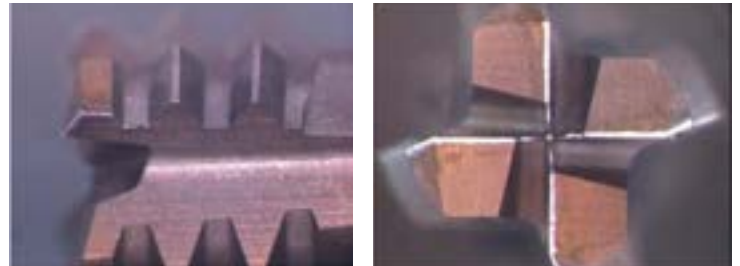
エポックDスレッドミル 600穴加工後の工具状態 Epoch D Thread Mill after threading 600 holes.
