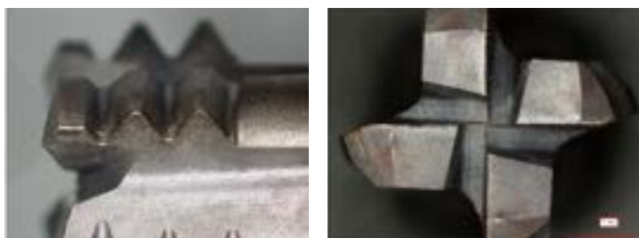
エポックDスレッドミル 50穴加工後の工具状態 Epoch D Thread Mill after threading 50 holes.
