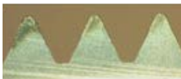
エポックスレッドミル 50穴加工後 Epoch Thread Mill after threading 50 holes
