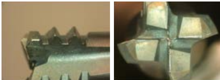
エポックDスレッドミル 150穴加工後の工具状態 Epoch D Thread Mill after threading 150 holes.
