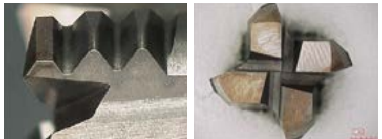
エポックDスレッドミル 64穴加工後の工具状態 Epoch D Thread Mill after threading 64 holes.
